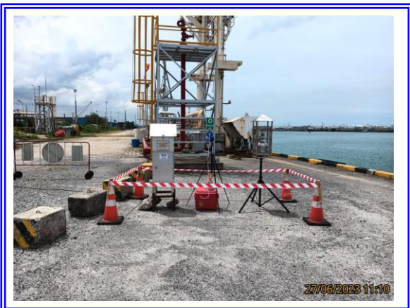
รูปที่ 4-44 แสดงการเก็บตัวอย่าง TSP และ NH 3 บริเวณอาคารควบคุมหน้าท่าเทียบเรือ (Unloading Arm) ระหว่างวันที่ 27-30 มิถุนายน 2566
